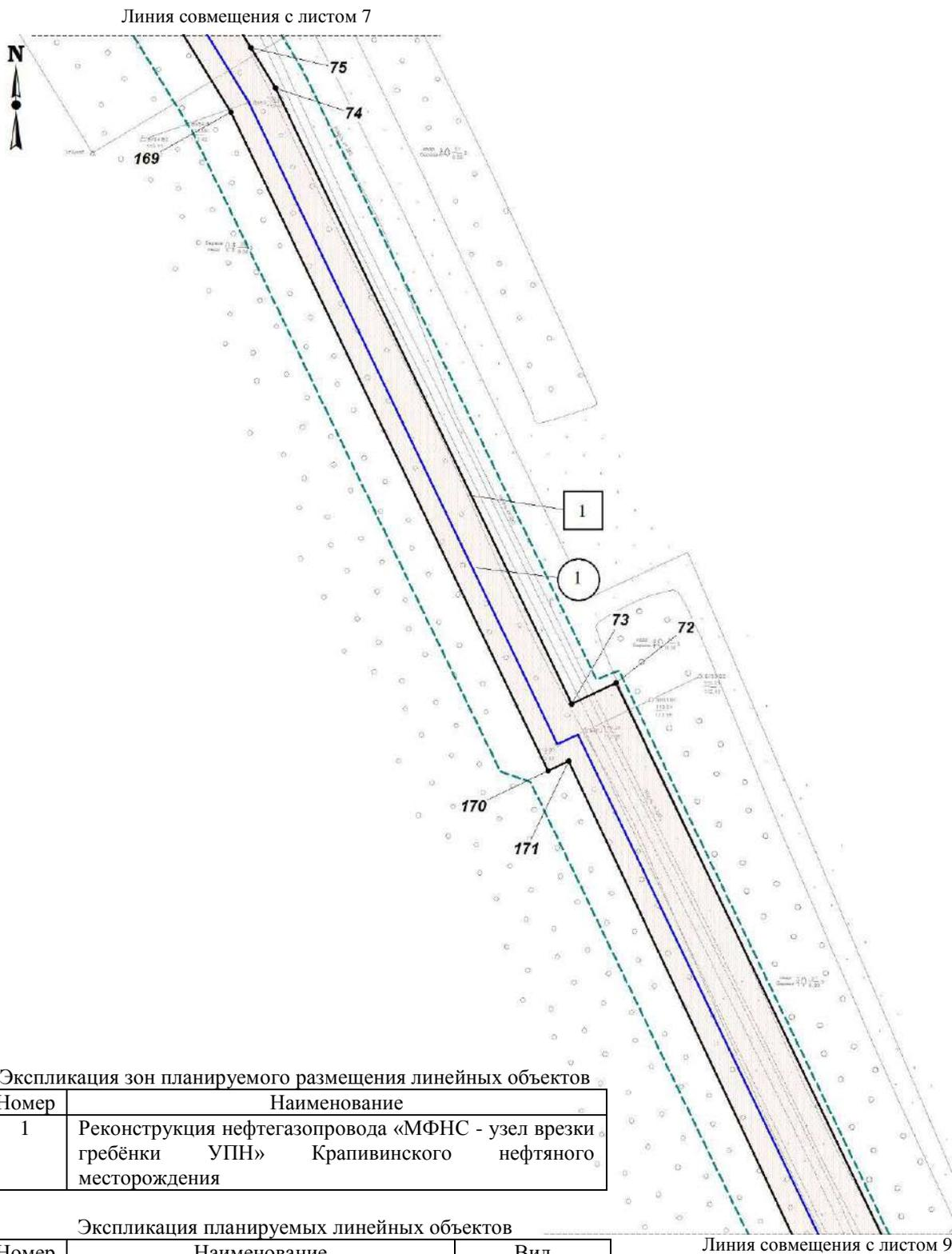
Чертеж границ зон планируемого размещения линейных объектов, подлежащих реконструкции в связи с изменением их местоположения по объекту «Реконструкция нефтегазопровода «МФНС - узел врезки гребёнки УПН» Крапивинского нефтяного месторождения»
